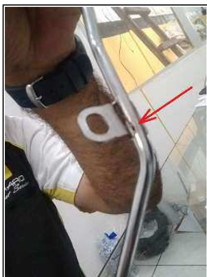
Foto 5 – Corrosão de um tubo de lubrificação de um Jet Sky YAMARA FX CRUIZER SHO
