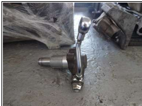
Foto 7 – Tubo de lubrificação avariado
