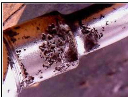
Foto 3 – tubo de lubrificação do tencionador da corrente de comando
