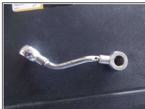
Foto 1 – tubo de lubrificação do tencionador da corrente de comando
