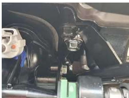
Foto 8 – Localização do tubo de lubrificação de uma moto aquática similar a moto examinada
