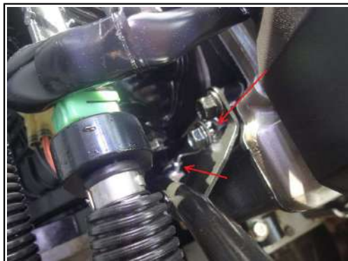
Foto 4 – tubo de lubrificação do tencionador da corrente de comando de uma moto aquática similar a moto examinada.
