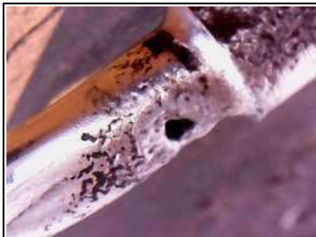
Foto 2 – tubo de lubrificação do tencionador da corrente de comando
