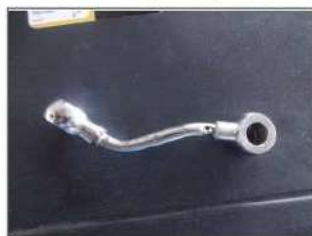
Foto 1 – tubo de lubrificação do tensionador da corrente de comando
